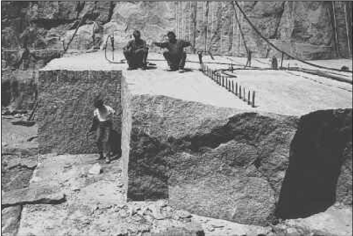
Abb. 6: Im Steinbruch: Die Keile sind in der Bruchzone eingeschlagen (Foto: Löhner)
