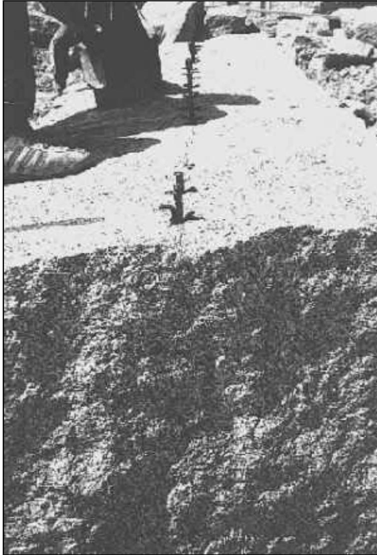
Abb. 2: Nachdem in den Granit Löcher gebohrt worden sind, steckt man in diese Keile hinein und treibt sie mit einem Hammer so lange immer tiefer hinein, bis dieser bricht. (Foto: (c) Löhner)
