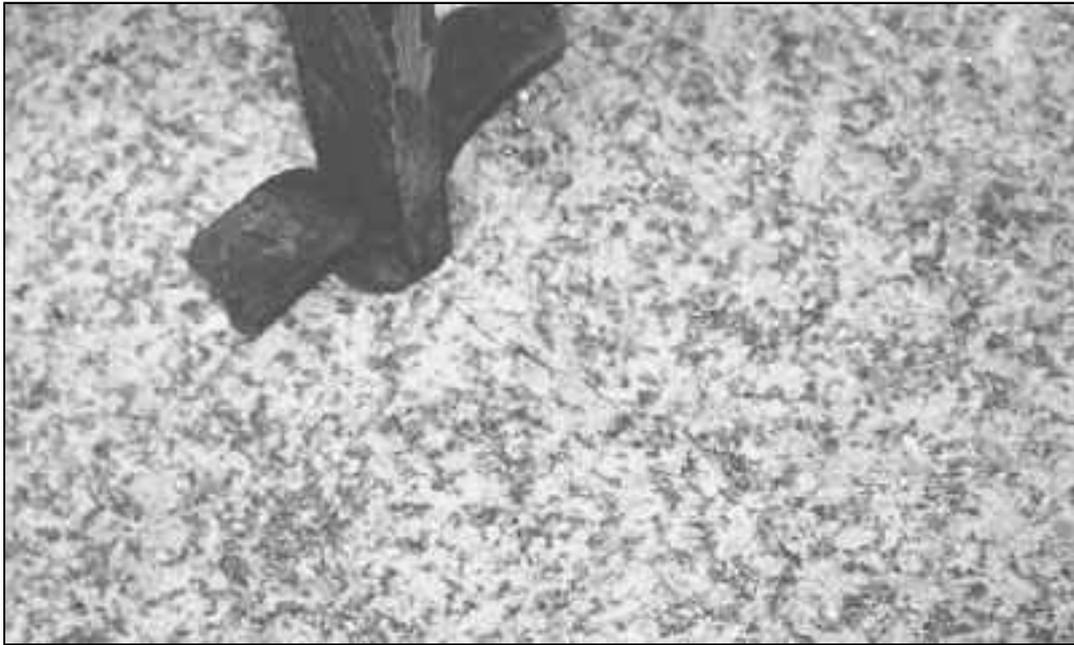
Abb. 7: Eingeschlagener Keil. Die Bruchzone ist gut erkennbar (Foto: (c) Löhner)
